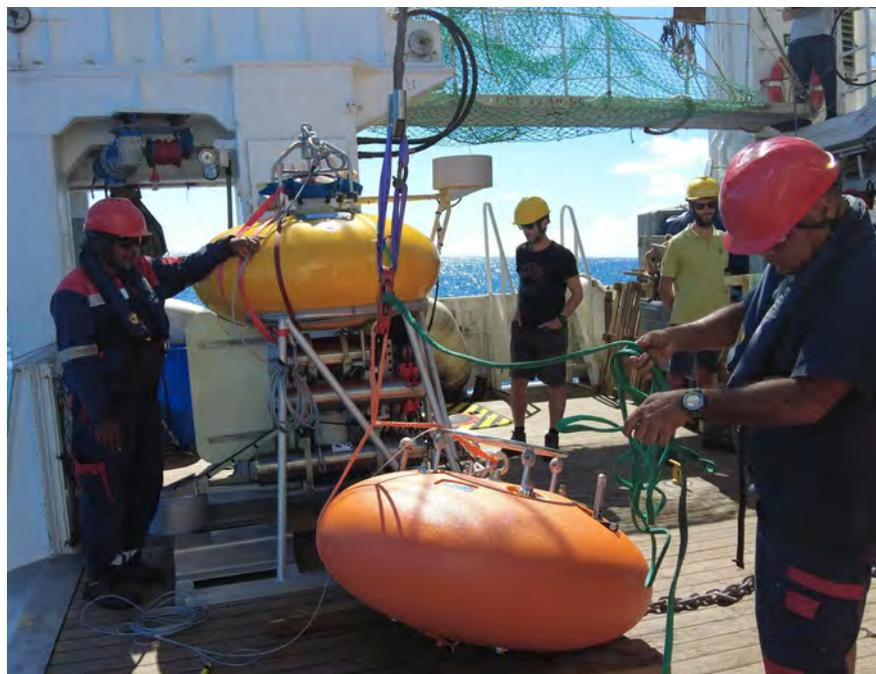
Mise à l'eau, depuis l'*Antéa*, d'une ligne de mouillage expérimentale dotée de capteurs et d'échantillonneurs pour observer les écosystèmes encore méconnus et riches en biodiversité des monts sous-marins de la mer de Corail en Nouvelle-Calédonie.
